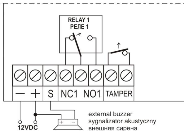
**ВАЖНО!** Сигнальный выход S не должен подключаться напрямую к (+) источнику питания (см. схему).
